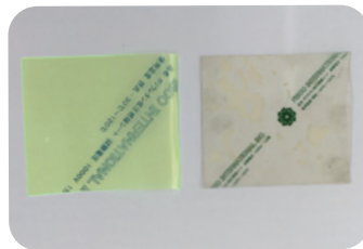
左：通常ピカイエローの状態 右：紫外線劣化した状態
