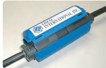
コードコネクタとプラグの接続後**Spinning lock**を被せ、施工します。4箇所を爪を切り込み差し込むだけで、簡単に取り付けられます。蓋が閉まらない時はプラグとコネクタのロックが不十分であることが判り、非常に簡単なチェック機構でもあります。(写真左)
