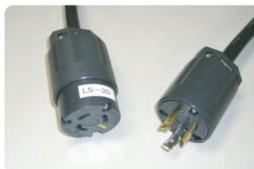
AMERICAN DENKI社製のNEMA規格のケーブルコネクタ&プラグは、差し込んだあと互いに右にひねる(右回転)と、端子が引っ掛かり抜け止めが作用してロックする。(写真左)
